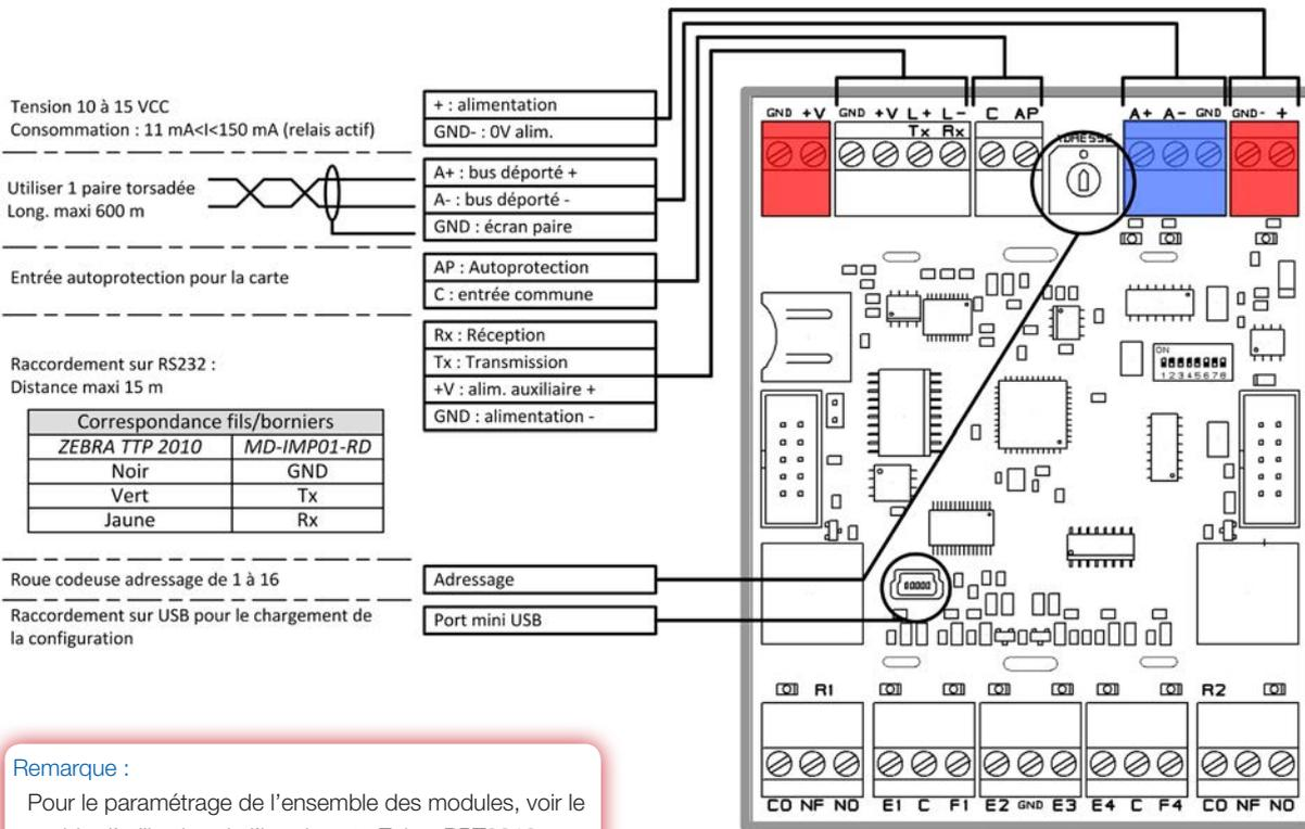
Protection des équipements : Afin d'assurer un parfait fonctionnement des équipements et éviter les interférences, raccorder le 0 volt des cartes électroniques à la terre.
